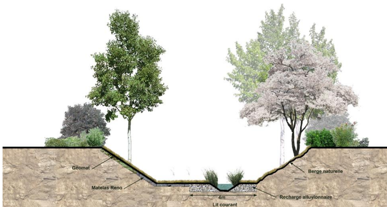
Figure 5 - Coupe type du lit du Rieumassel après réalisation du projet – Source : AVP
